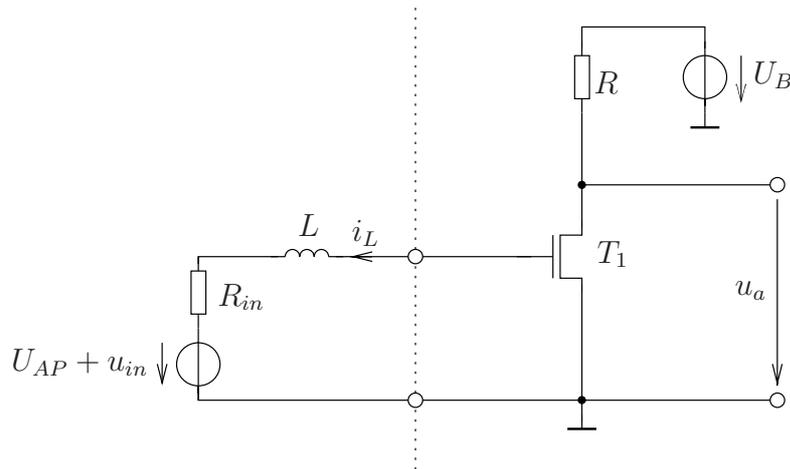
Bei dem verwendeten Transistor ist die parasitäre Gate-Drain Kapazität besonders groß. Diese soll deshalb bei der Modellierung berücksichtigt werden. Verwenden Sie für die weitere Aufgabe folgendes Kleinsignalersatzschaltbild für  $T_1$ .
