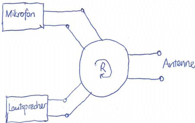
Außerdem werden Zirkulatoren auch beim Hochfrequenztechnik ~~in~~ in Radargeräten eingesetzt.
