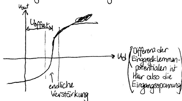
Die rechte Übertragungskennlinie wird damit zum Ursprung verschoben und der Arbeitspunkt des OpAmps befindet sich im Ursprung. Außerdem vernachlässigt man ~~den~~ <sup>den</sup> sehr kleinen Eingangsleitwert und sehr kleinen Ausgangswiderstand, wodurch der ideale Operationsverstärker mit unendlicher Verstärkung erreicht wird:
