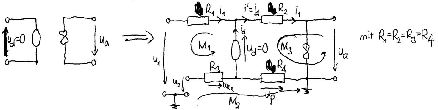
Man kann an dieser Stelle entweder mit Hilfe der Vorüberlegungen oder da  $u_d$  über ein Nullator abfällt, feststellen, dass  $u_d = 0$  gilt.
