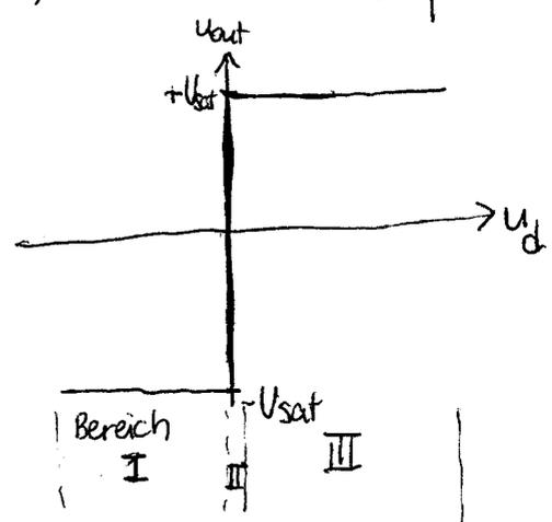
Jetzt ist es sinnvoll, die stückweise lineare Übertragungskennlinie mithilfe der Unterscheidung angedeuteter Bereiche weiter zu charakterisieren und die Ersatzschaltbilder für diese Bereiche herleiten.
