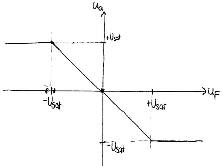
l) Die Ausgangsspannung ist die negative der Differenz  $u_F = u_1 - u_2$ , deswegen ist diese Schaltung ein Subtrahierer.
