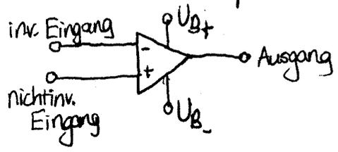
Jedoch kann man diese als ein Zweiter auffassen, indem man die Betriebsspannungsquellen ins Innere des Bauteils zieht und nur eine Verbindung für die Erhaltung der Torbedingungen stellt:
