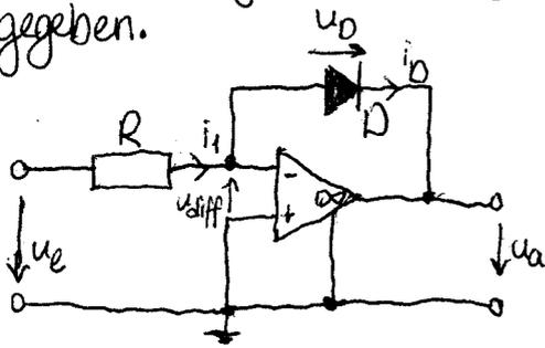
→ Anmerkung: In dieser Aufgabe wird zur Notation der Differenzspannung nicht die übliche  $u_D$ , sondern  $u_{diff}$  verwendet, da  $u_D$  und  $i_D$  sich auf die pn-Diode beziehen.
