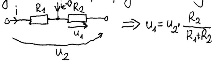
Herleitung: Strom über Widerstände ist gleich, da der Eingangsstrom gleich zu Null ist.
