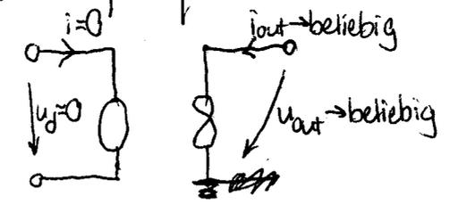
• Bereich III) heißt auch „positive Sättigung.“ Offensichtlich ist die Voraussetzung für diesen Arbeitsbereich  $u_d > 0$  und es gilt  $u_{out} = U_{sat}$ . Außerdem ist wieder  $i = 0$  und  $i_{out}$  beliebig. Deswegen kann man den Eingang mit einem Leerlauf und Ausgang mit einer Spannungsquelle modellieren, was das folgende ESB ergibt:
