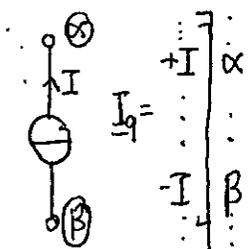
Also soll in die Zeile  $\alpha$  des Vektors  $I_q$  der Stromwert und in die Zeile  $\beta$  von  $I_q$  der Negative des Stromwerts eingetragen werden. Wenn  $\alpha$  oder  $\beta$  Massenknoten ist fällt der entsprechende Eintrag weg.
