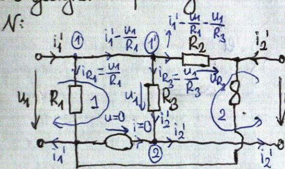
→ Torbedingungen: Ein- & Auslaufende Ströme eines Tors sind gleich groß.
