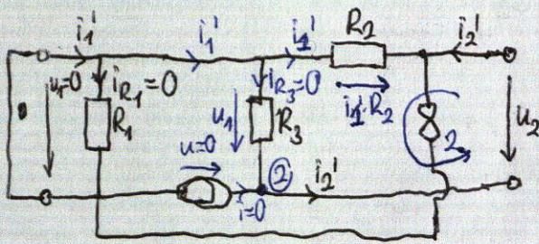
• Wegen  $u_1=0$  fließt bei  $R_1$  und  $R_3$  kein Strom.
