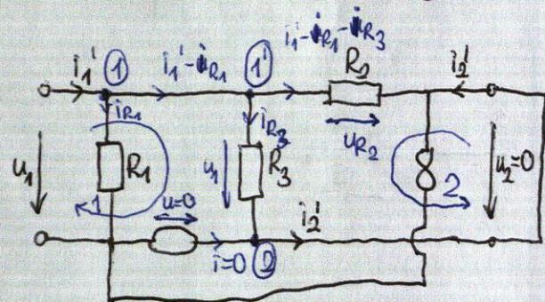
→ KVL bei 1:  $u_1 = u_{R_3} - u = u_{R_3}$
