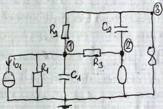
Nun soll der resistive, quellenfreie Teil der Schaltung in den gegebenen Rahmen eingebettet werden. Da die gegebene Knotennummerierung auch gelten soll, muss die linke untere Klemme an Masse liegen, da die Kapazität  $C_1$  und Stromquelle  $i_0$  zwischen dem Knoten 1 und der Masse liegen. Analog soll die rechte untere Klemme dem Knoten 2 entsprechen, weil die Kapazität  $C_2$  zwischen 2 und 3 liegt.
