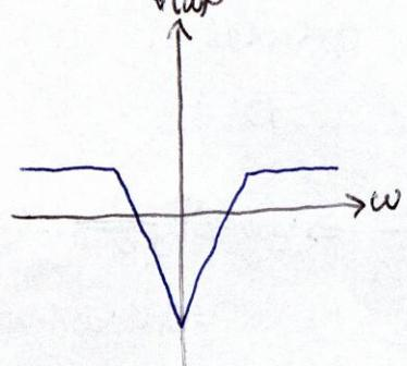
Bandsperr → ein Band von Freq. wird gesperrt.
