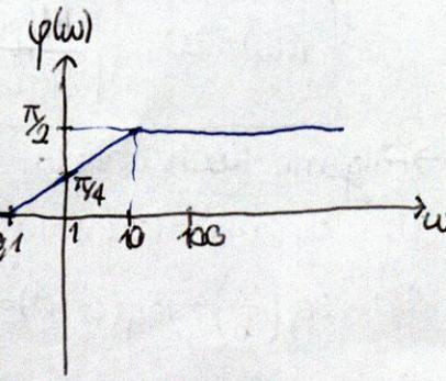
$$\varphi(\omega) \approx \begin{cases} 0 & \text{für } \omega < 0,1 \\ \frac{\pi}{4} [\log \omega + 1] & \text{für } 0,1 < \omega < 10 \\ \frac{\pi}{2} & \text{für } \omega > 10 \end{cases}$$
