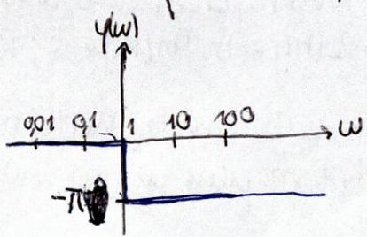
→ Wenn man also  $H(j\omega) = (1 - j\omega) \cdot \frac{1}{1 + j\omega}$  als Übertragungsfunktion hat, soll man lediglich die Bodediagramme  $H_1(j\omega) = 1 - j\omega$  und  $H_2(j\omega) = \frac{1}{1 + j\omega}$  jeweils für v und \varphi aufaddieren, um auf das Bodediagramm von  $H(j\omega)$  zu kommen. Für Beispiele siehe Skriptum.
